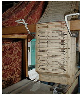
Εικόνα 2.5. Η μηχανή του Jacquard
